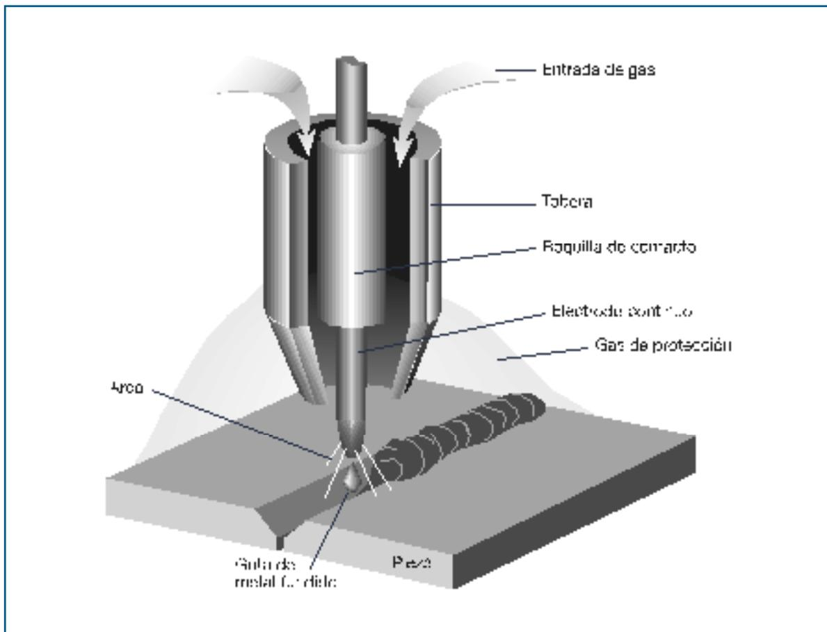
En el sistema MIG, un sistema de alimentación impulsa en forma automática y a velocidad predeterminada el alambre-electrodo hacia el trabajo o baño de fusión, mientras la pistola de soldadura se posiciona a un ángulo adecuado y se mantiene una distancia tobera-pieza, generalmente de 10 mm.
